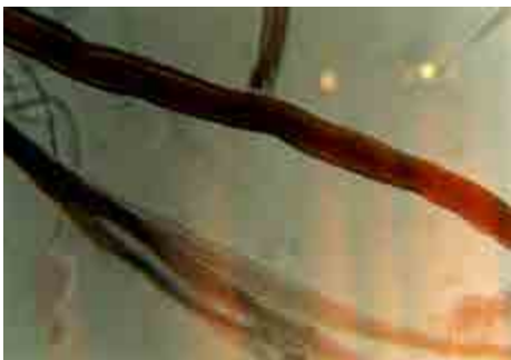
عکس شماره ۱۱- الیاف کاغذ قرآن نمونه ۲، رنگ آمیزی با معرف هرزبرگ، بزرگنمایی ۲۰۰X.
